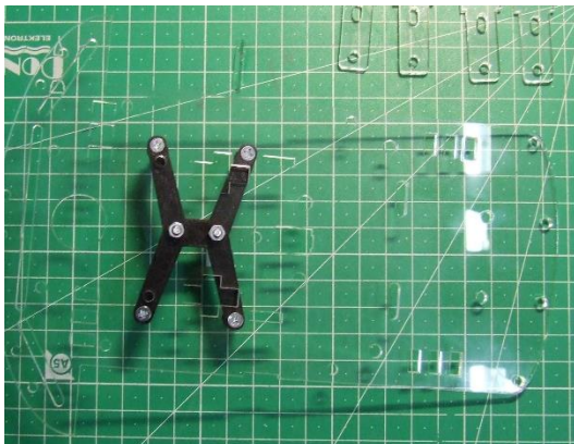
3. Rögzítsük a megadott helyre 2db (M3x10) csavar segítségével
