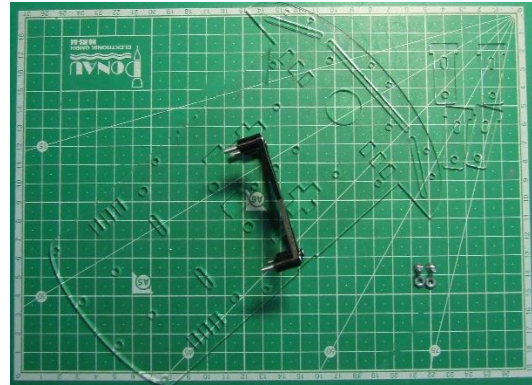
2. Helyezzük be 4 db (M3x20) csavart a motorvezérlő távtartójába
