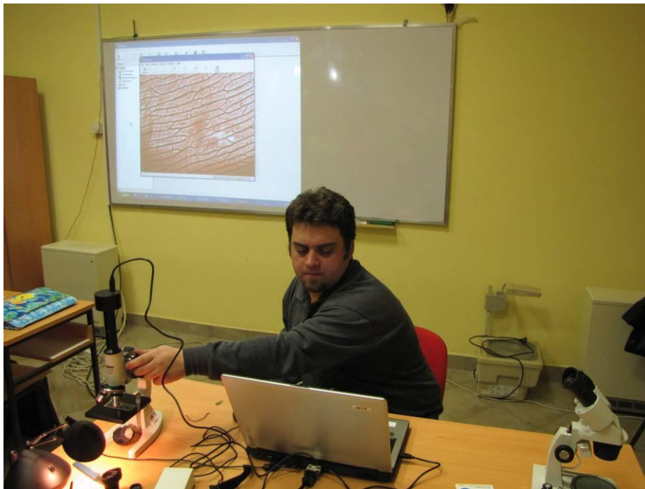
A mikroszkóp csövébe helyezhető kamera segítségével kivetíthető a preparátum
