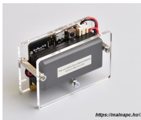
5. ábra Az elemek ennél a típusnál csak a tartó lecsavarása után érhetők el.
